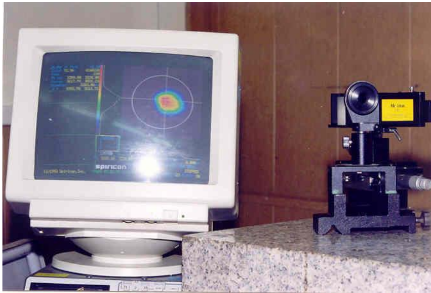
Рис. 1.4. Загальний вигляд аналізатора Silicon Camera Model LBA–100A
