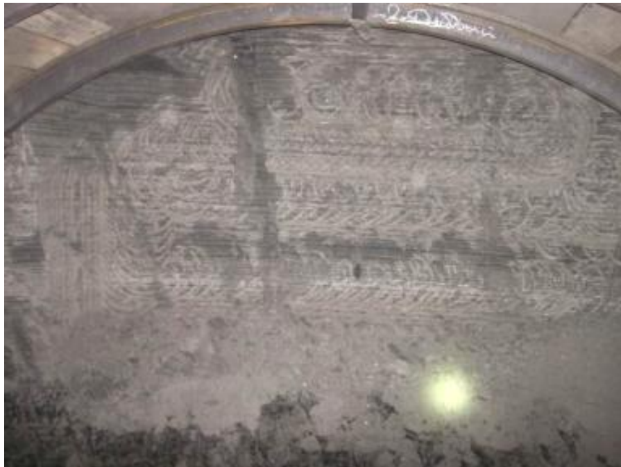
Мал. 2.6. Зони тріщинуватості в забої 163-го бортового штреку шахти «Степова»
