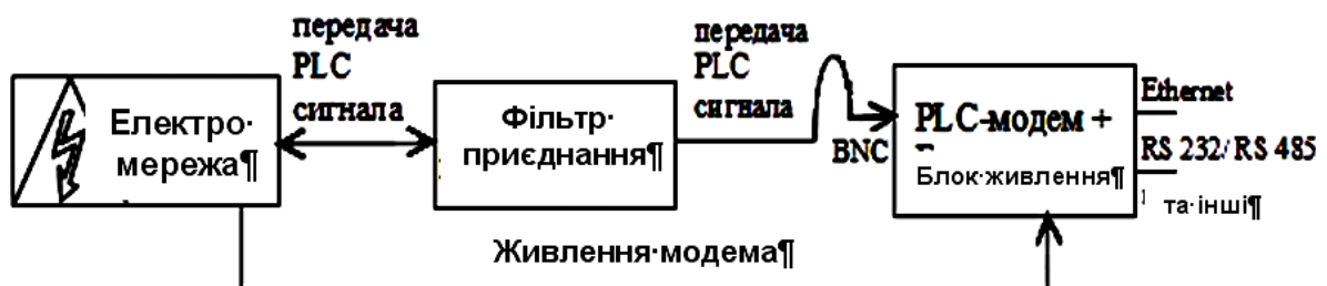
Рисунок 1.17 – При підключенні модему використовуються електромагнітні або ємнісні пристрої приєднання до мережі 220 В – 1 кВ
