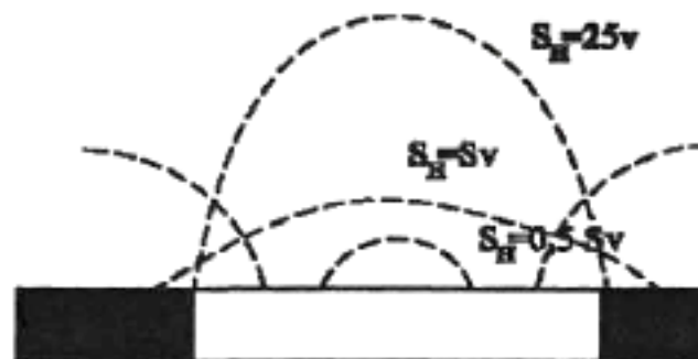
Рис. 2.5. Зміна контуру коефіцієнта безпеки залежно від горизонтальних напружень для відношення міцність/напруження = 4: S_{v,0} – початкові вертикальні напруження в масиві, S_{H,0} – початкові вертикальні напруження в масиві
