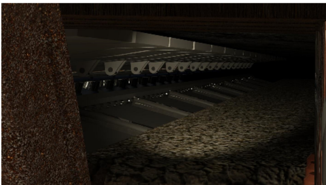
Рис. 2.13 Закладка присекаемой породы
