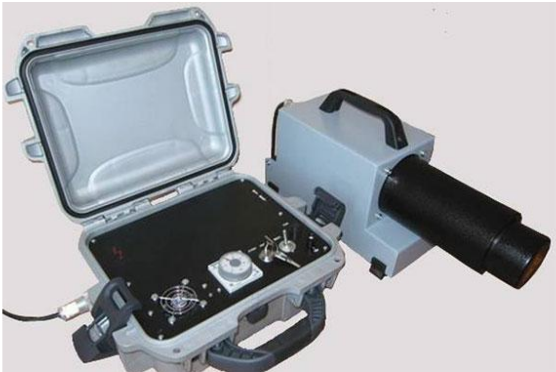
Рис. 3.2. Портативний рентгенівський апарати для роботи в важких умовах
