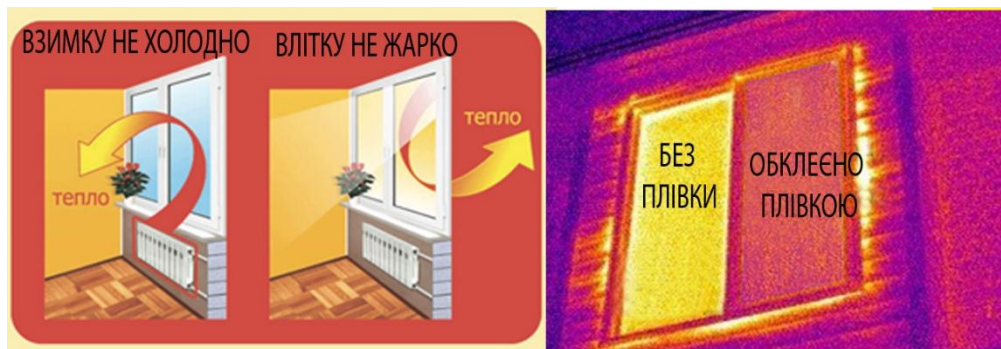
Рис. 3. Принцип роботи теплозберігаючої плівки
