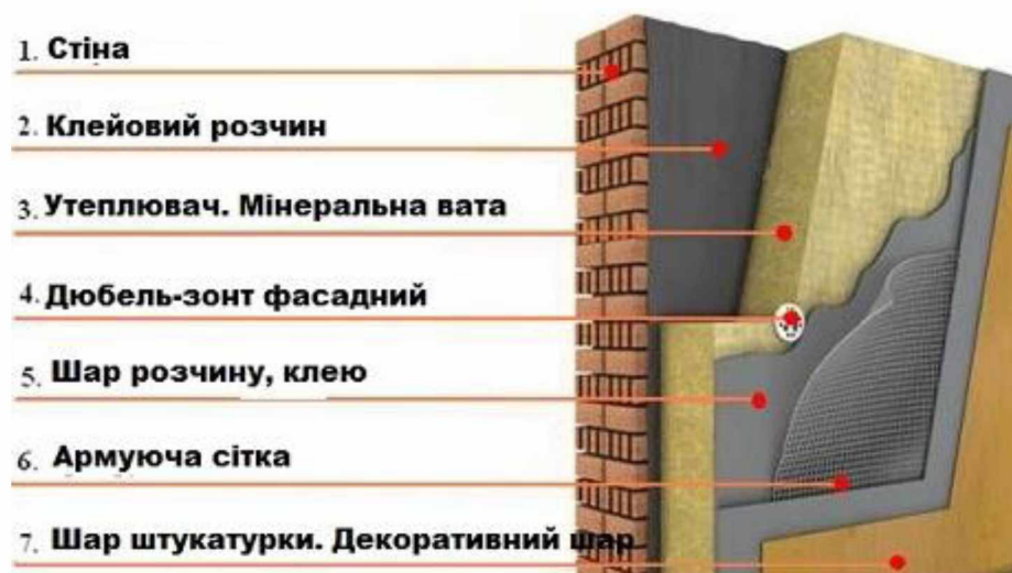
Рисунок 2.1 - Технологія утеплення стіни мінераловатними матами
