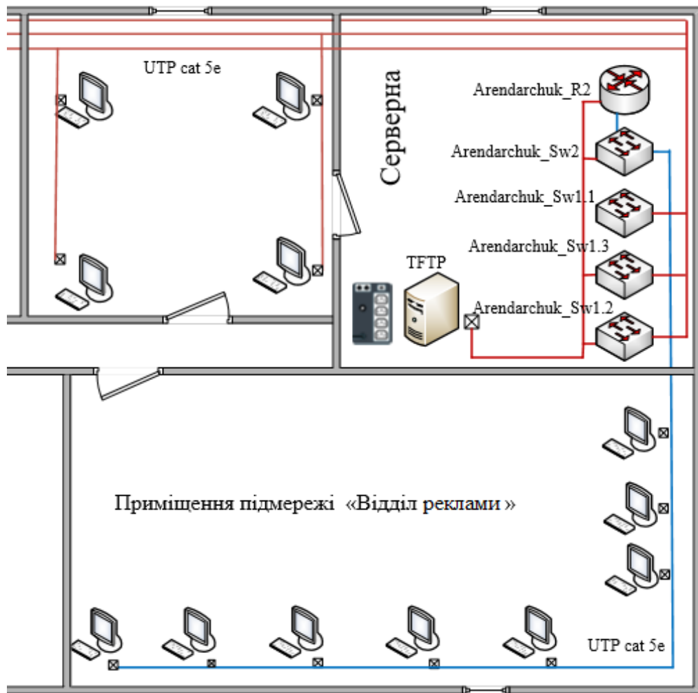
Рисунок 4.1 – Схема фізичної топології мережі адміністративної будівлі
