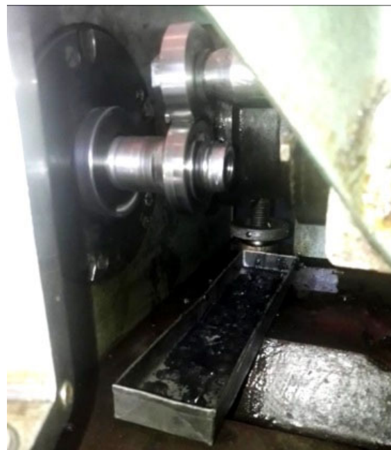
Рисунок 1 – Розміщення зразків на машині тертя СМЦ-2
