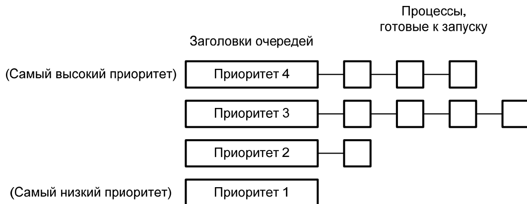
Рисунок 4 – Приоритетный алгоритм планирования с четырьмя классами приоритетов.
