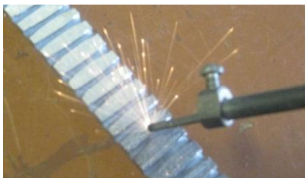
Рисунок 4 – Процес нанесення покриття при ЕІЛ
