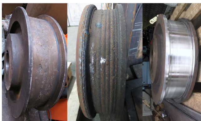
Рисунок 1 – Ходові колеса з зносом
