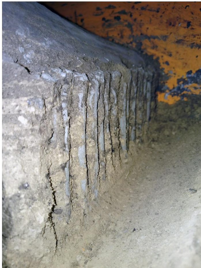
Рис. 2.14 Модель схилу з ґрунтоцементними палями після обертання на центрифугі. Виймання передньої частини ґрунту для обстеження стану паль
