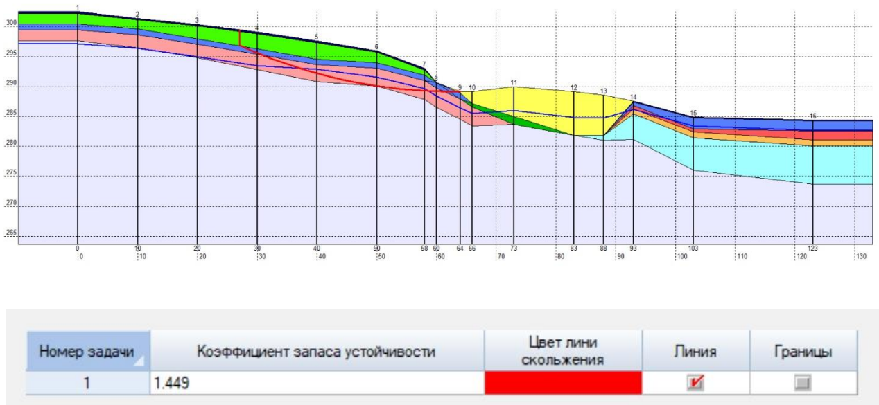
Рис. 4.2 Результати розрахунку стійкості схилу за методом Бішопа (спрощений), K=1,449
