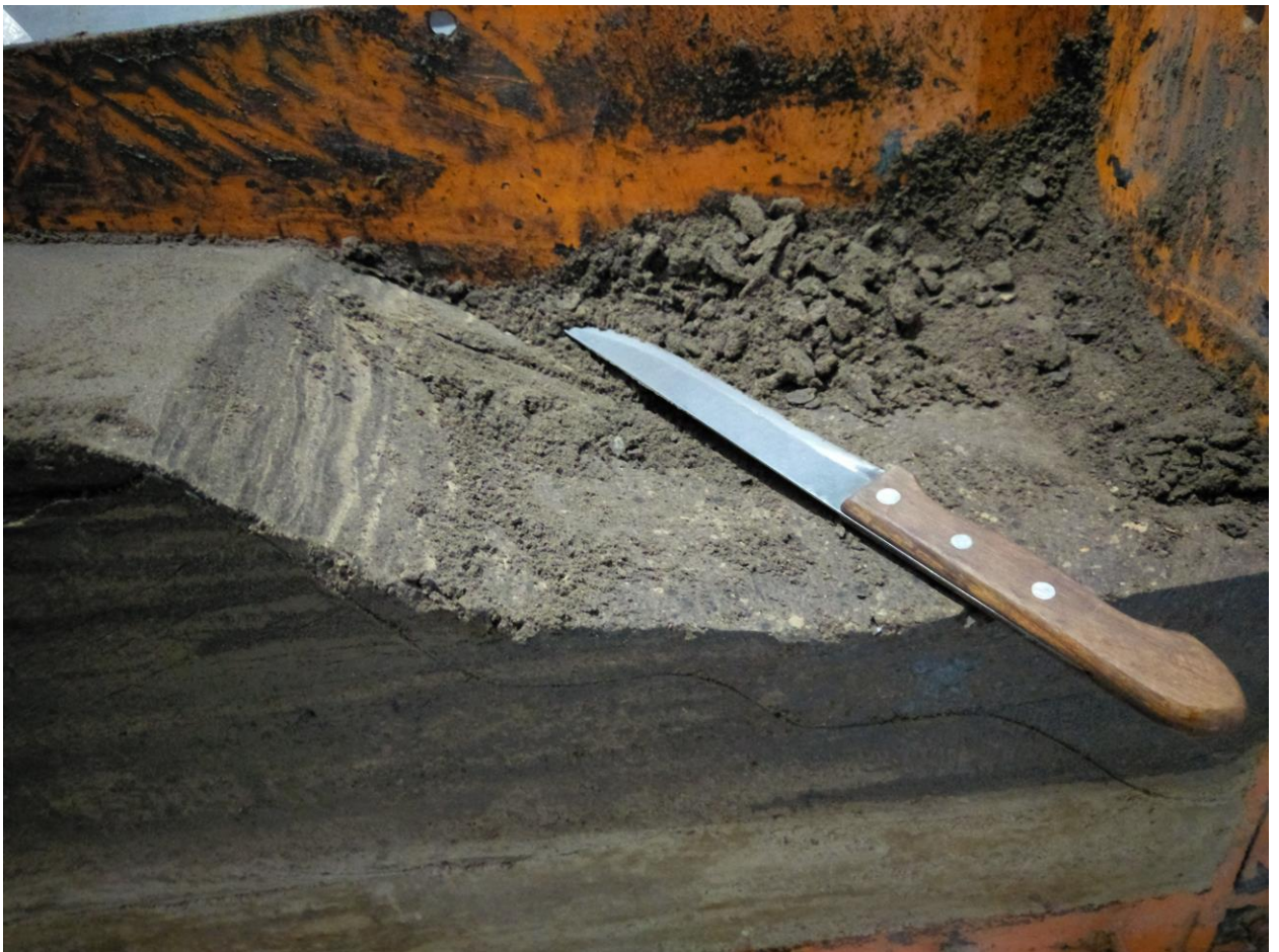
Рис. 2.8 Підрізання втрамбованого ґрунту згідно обрису схилу
