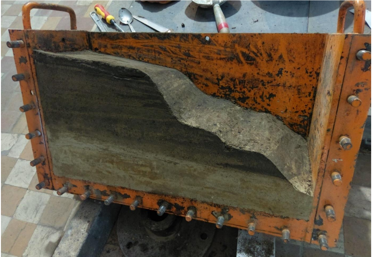
Рис. 2.9 Модель у масштабі 1:100 після підрізання зайвого ґрунту
