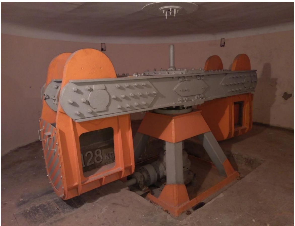
Рис. 2.6 Фотографія центрифуги, на якій проводились дослідження стійкості моделі схилу балки Довгий байрак
