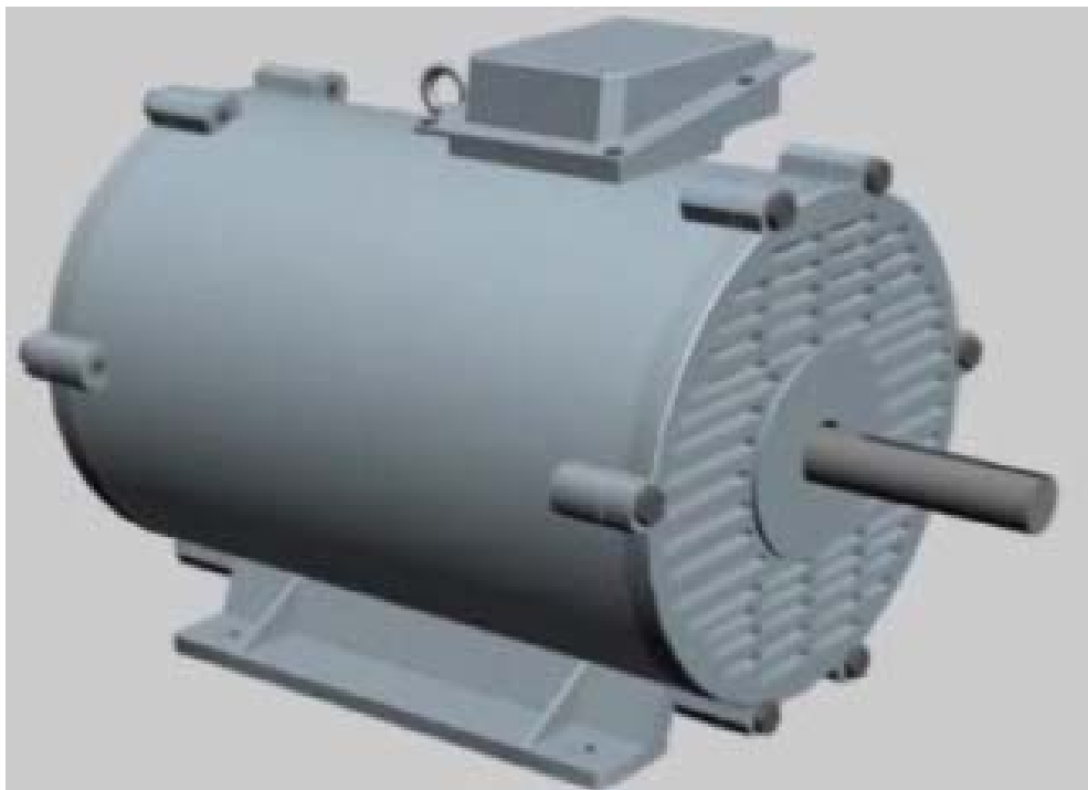
Рис. 10. Тривимірна модель машини постійного струму в середовищі 3D Studio MAX
