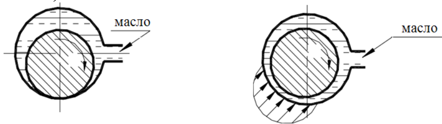
Рис. 4.7 Схема роботи гідростатичного плаваючого вкладиша підшипника ковзання
