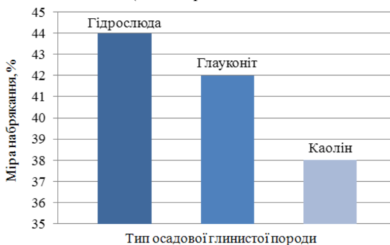
Рис. 5.3. Залежність міри набрякання основних типів глинистих порід для умов застосування в якості реагенту-регулювальника карбоксиметилцелюлози (КМЦ)
