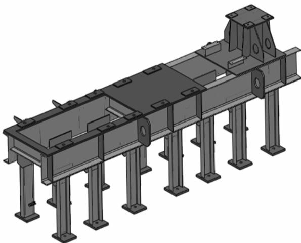
Идея работы заключается в определение рационального количества стоек и такого расположения их по длине, при котором максимально полно будет использоваться жесткость горизонтальных балок рамы с тем, чтобы не превзойти допустимые величины деформаций рамы. Такие деформации должны исключить взаимное смещение и перекосы концов валов двигателя и редуктора, соединяемых муфтой, выше допустимых норм [1, 2].
