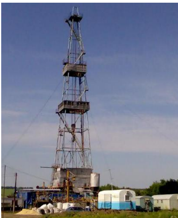
Рисунок 2.6. Бурова установка УРАЛМАШ 4000/320 ДГУ-1
