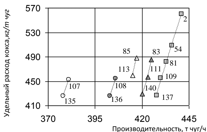
Рис. 3. Характеристика дутьевого режима решения задачи векторной оптимизации в области «удельный расход кокса - производительность» для ДП №9 ПАО «АМКР» при отсутствии вдувания природного газа (ПГ) и изменении расхода пылеугольного топлива (ПУТ) (числовые значения возле точек, кг/т чуг) и температуре дутья, содержанию кислорода: о- (1200 °C; 27%); о- (1200 °C; 29%); Δ- (1080 °C; 31%); Δ- (1140 °C; 31%); □- (1200 °C; 31%)
