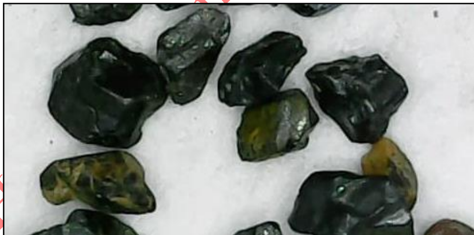
Рисунок 4.5 - Ільменіт з примазками та плівками сидериту та лімоніту. Збільшення 140 x
