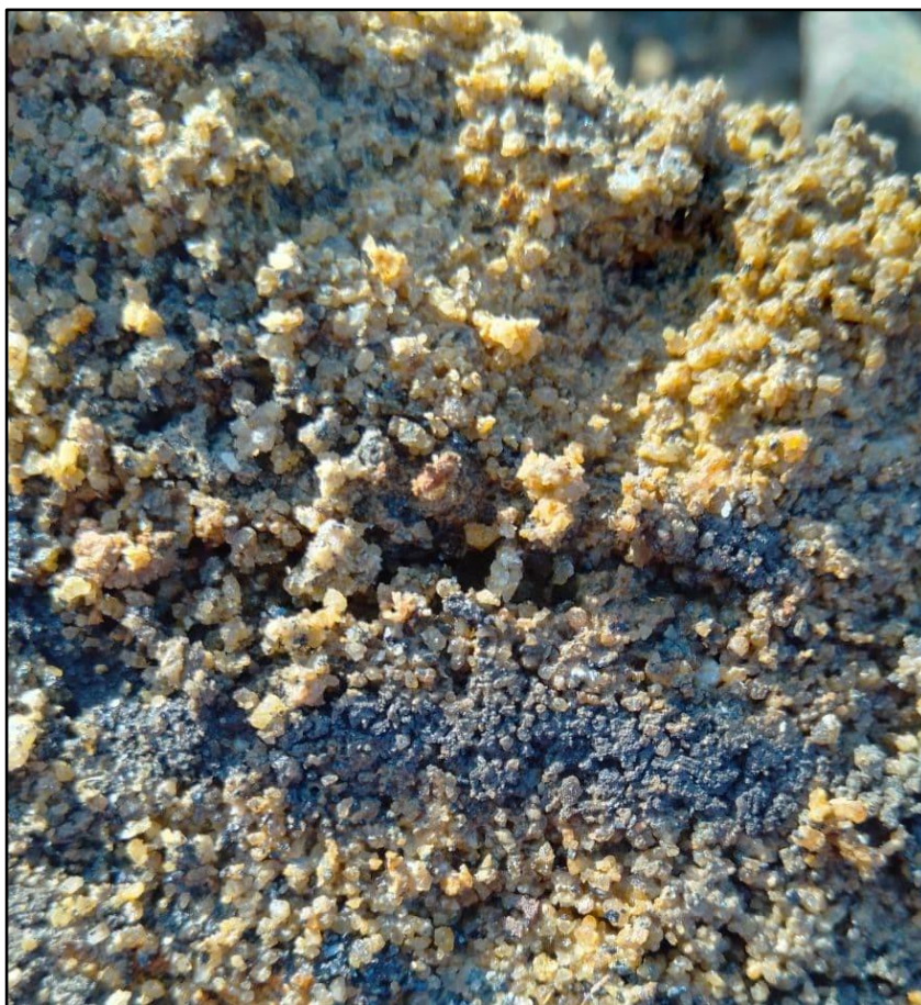
Рисунок 4.1 – Кварцевий ільменітовміщуючий пісок, глинистий. Збільшення 40 x
