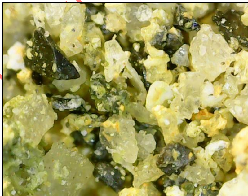
Рисунок 4.2 - Піски різнозернисті з глинистими частками. Збільшення 250 x
