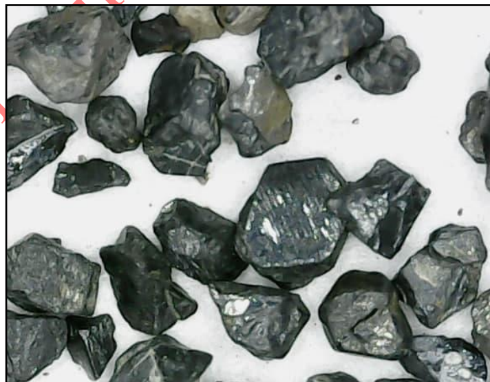
Рисунок 4.3 - Ільменіт. Збільшення 140 x
