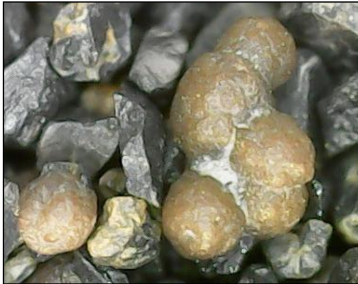
Рисунок. 4.4 - Сфероліти сидериту. Збільшення 140 x
