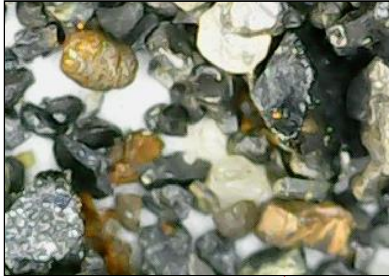
Рисунок 4.6 - Уламки альмандину. Збільшення 140 x
