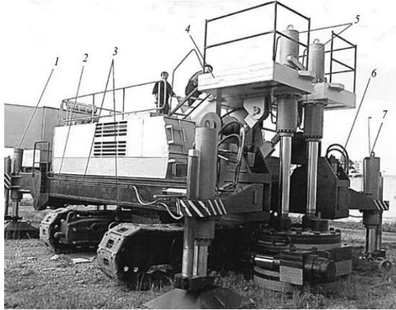
Рисунок 5.6 – Установка вдавнення палей УСВ 160:
