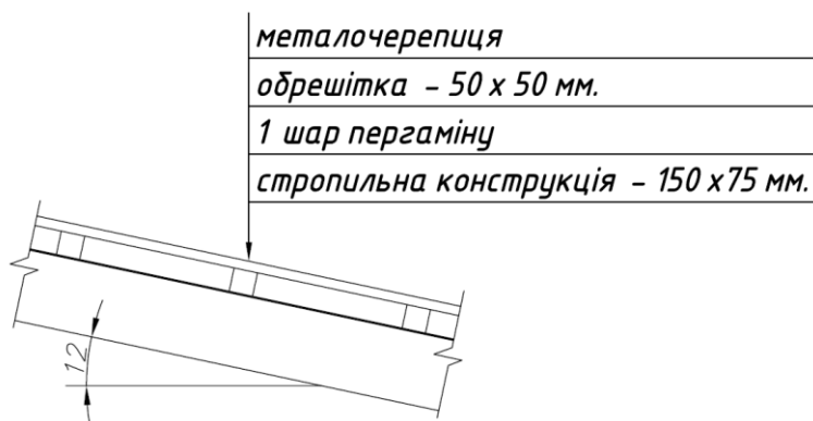
Рисунок 2.1 — Шари покрівлі.
