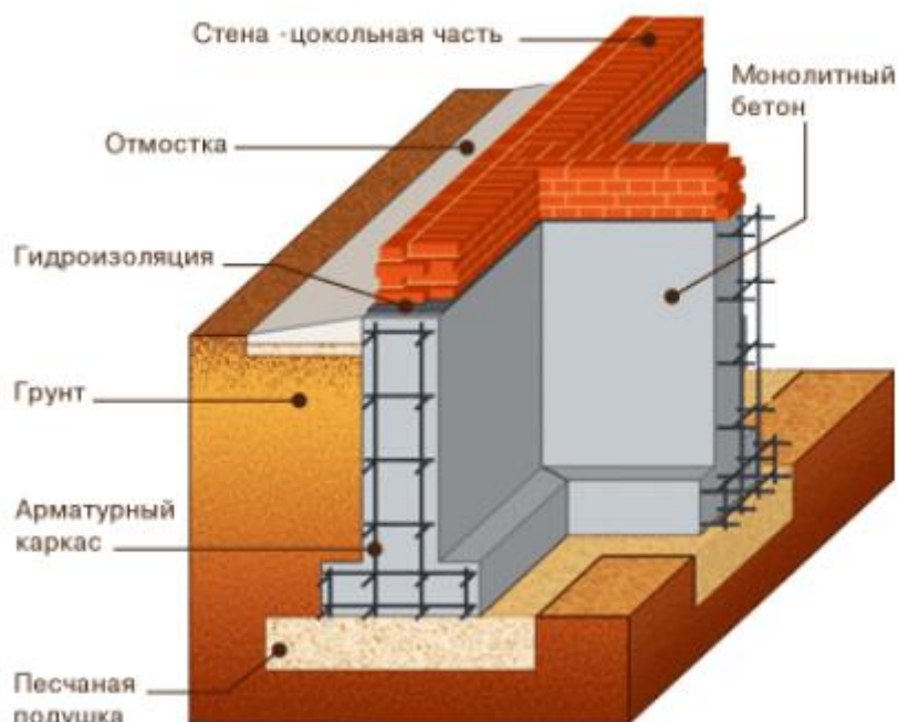
Рисунок 2.1 – Монолітний стрічковий залізобетонний фундамент
