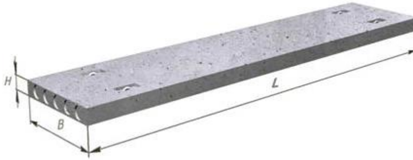
Рисунок №2.6 – Плита перекриття (принциповий вигляд)
