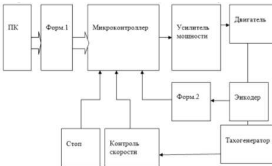
Рисунок 1.8 – Структурна схема системи керування серводвигуном
