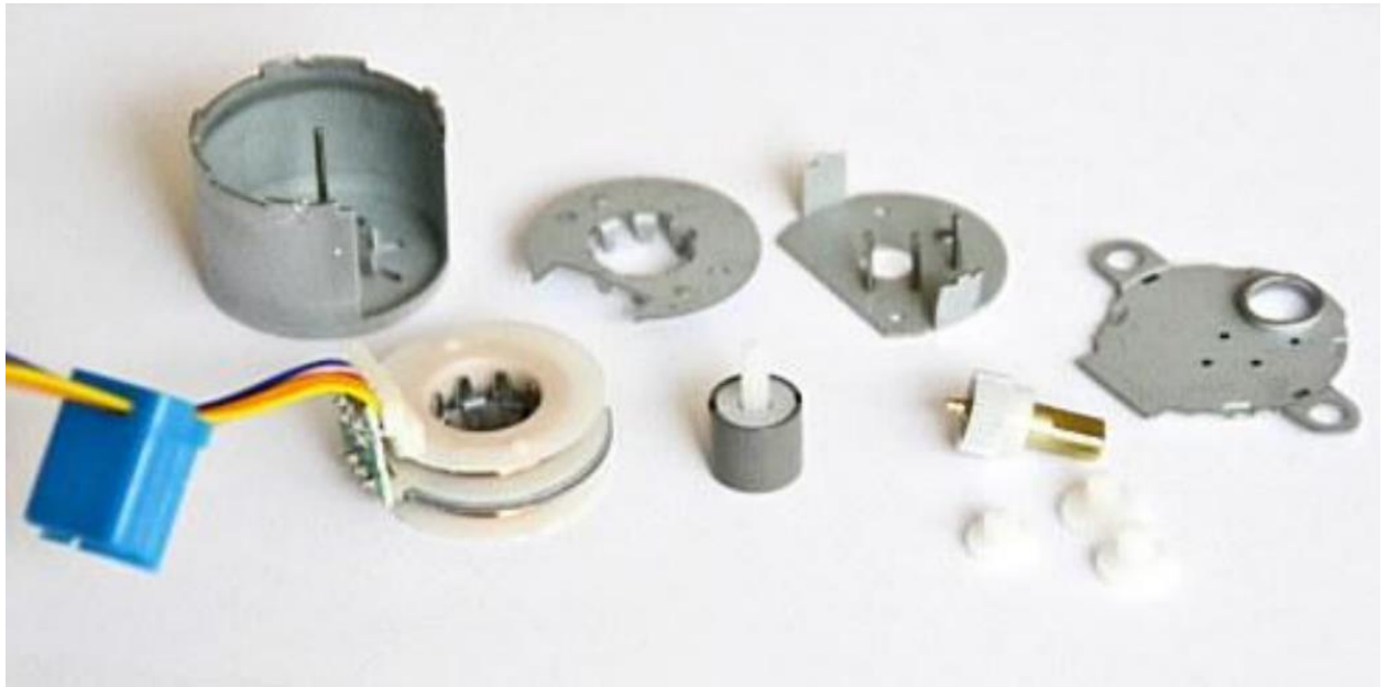
Рисунок 2.4 – Зовнішній вигляд деталей редуктора та двигуна «28BYJ – 48 – 5V»
