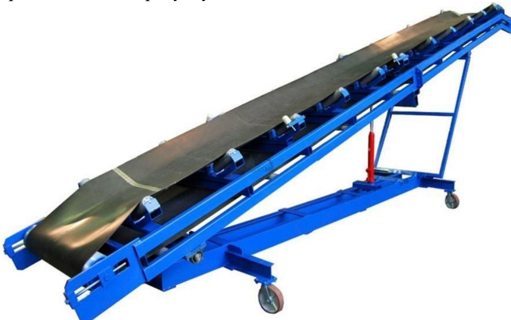
Рисунок 2 - Конвейер стрічковий жолобчастий мобільний з регулюванням кута нахилу
