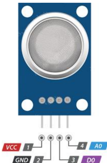
Рис.2.5.13 Розпіновка модуля датчика диму MQ-2
