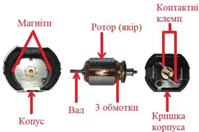
Рис. 2.2.2. Креслення мікродвигуна постійного струму з редуктором 12GAN20
