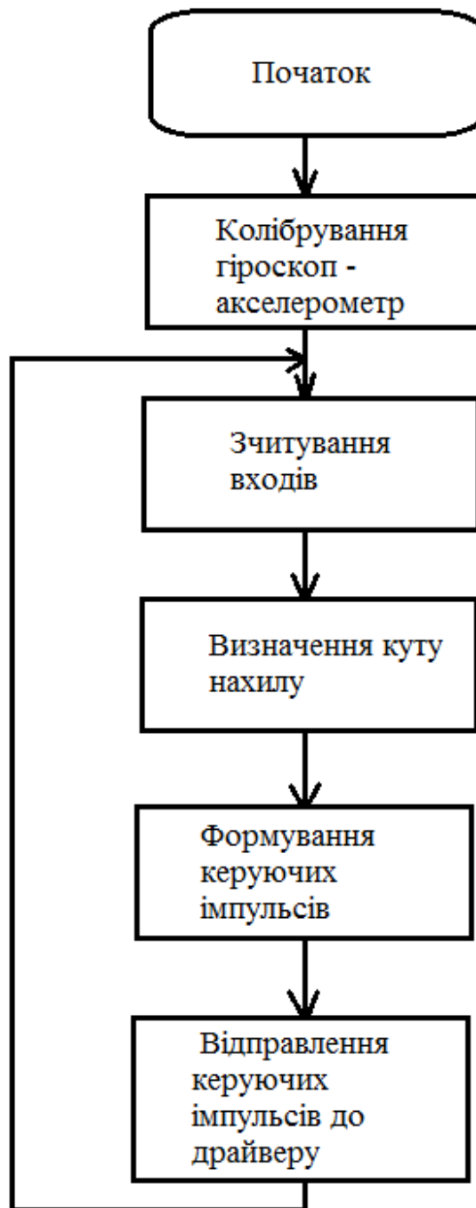
Рис. 3.3 Блок – схема роботи програми балансуючого візка
