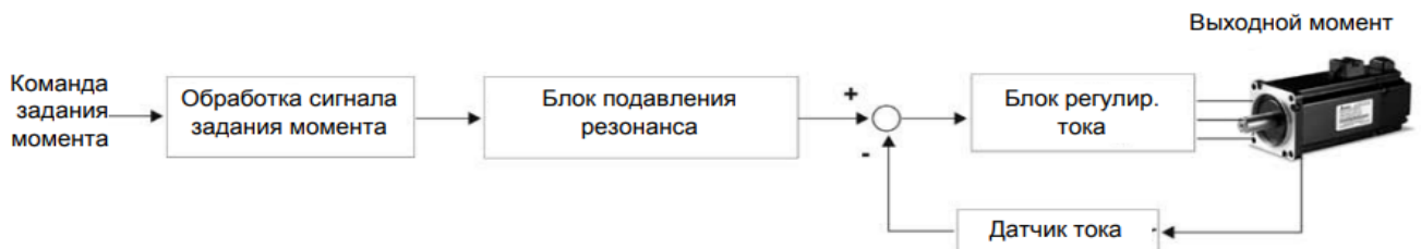
Рисунок 3.8 Базова структура обробки сигналу завданням моменту
