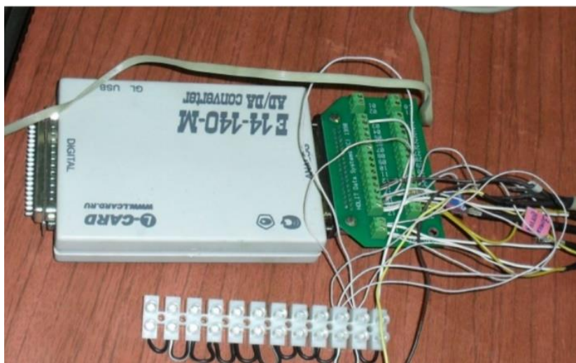
Рис. 3.1. Зовнішній модуль АЦП E14-140M з клемником
