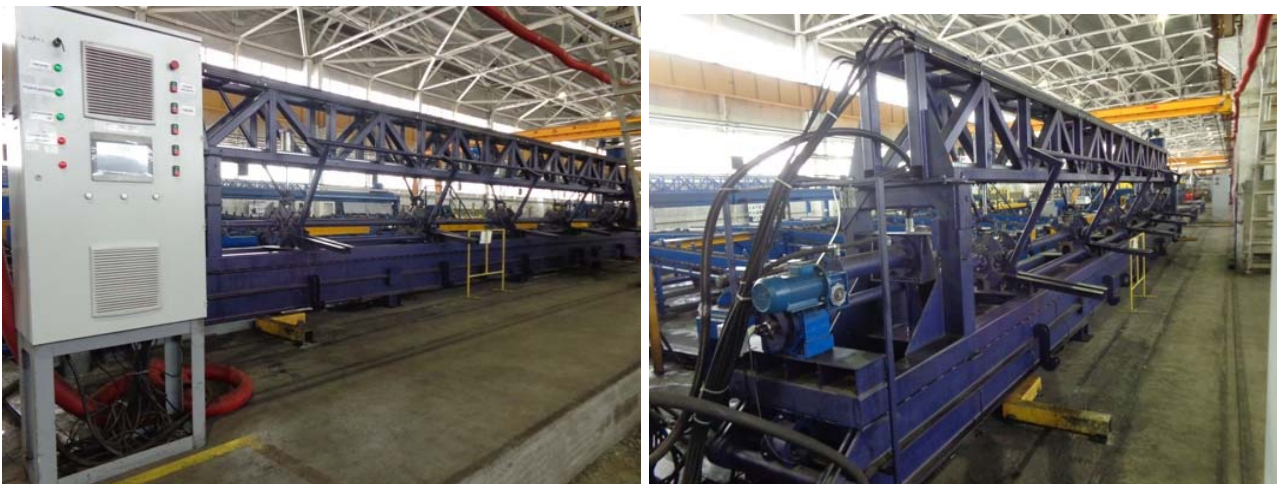
Рисунок 1.5 – Стенд для гідравлічних випробувань труб діаметром 89...219 мм
