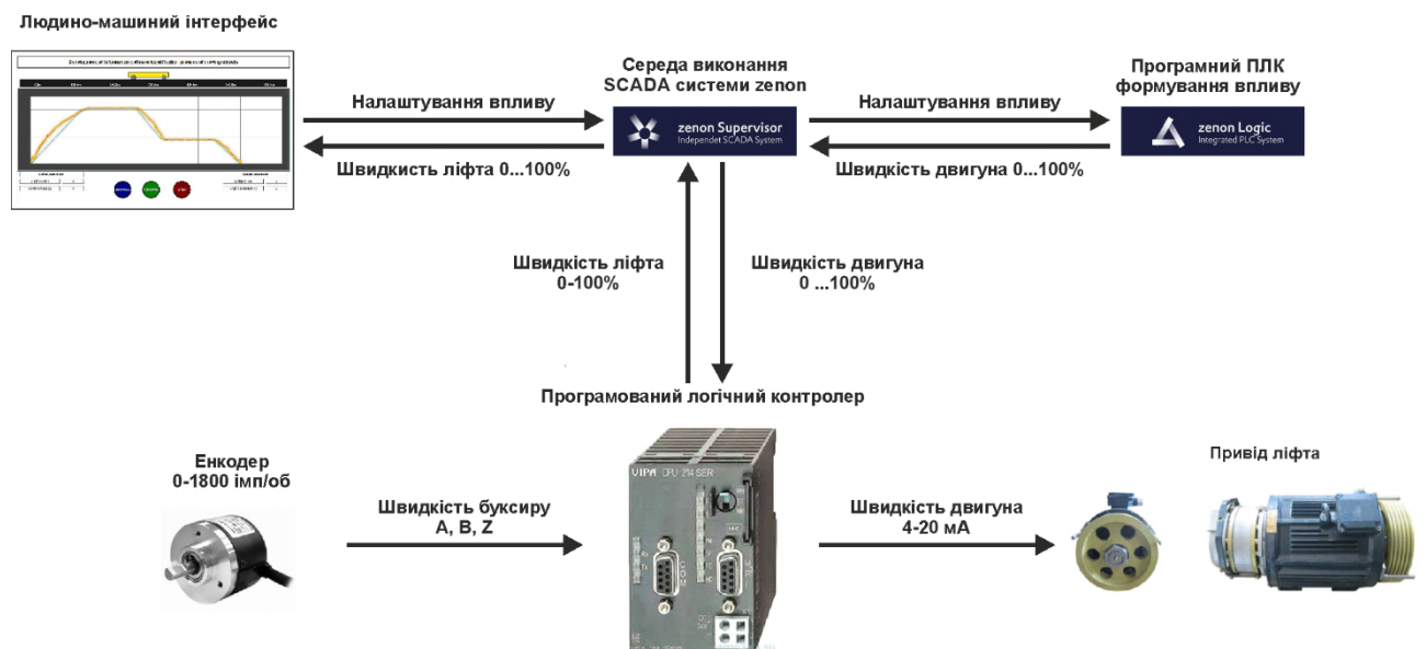
Рисунок 3.1 – Структурна схема інформаційних потоків дослідницької системи
