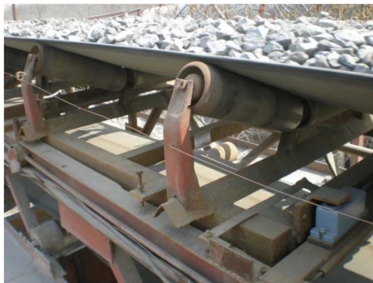
Рисунок 1.3 - Електронні конвеєрні ваги з двома штатними роликооперами
