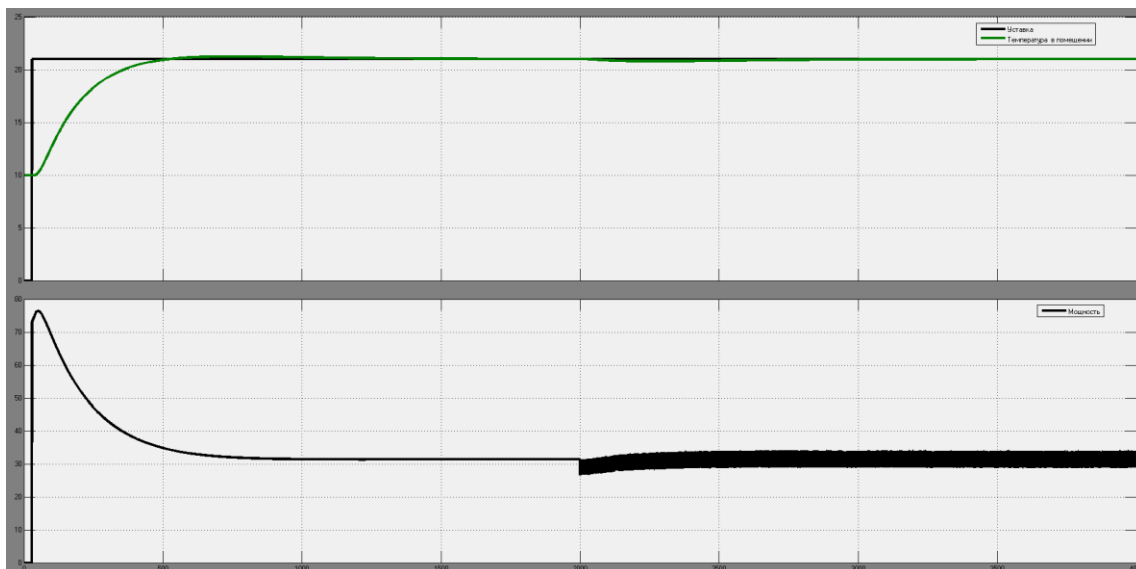
Рисунок 3.10 – Результати моделювання системи керування з ПІД регулятором та збурюючим впливом
