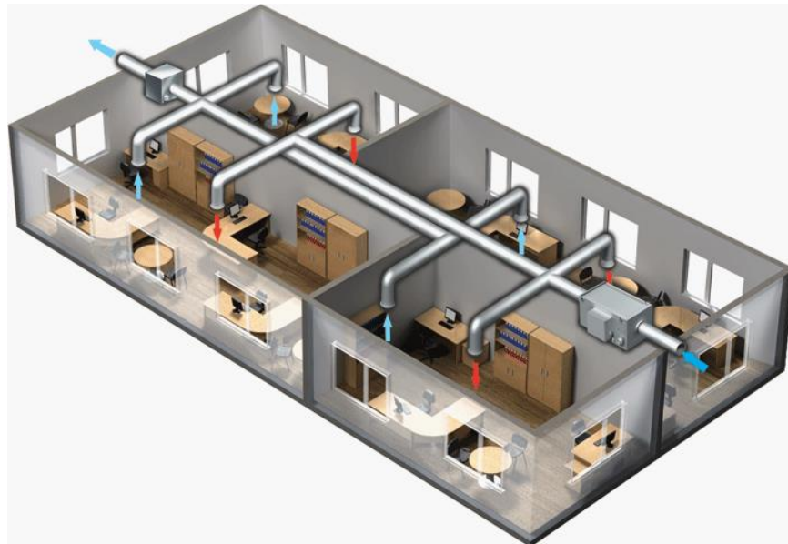
Рисунок 1.1 – Офісне приміщення з припливною вентиляцією
