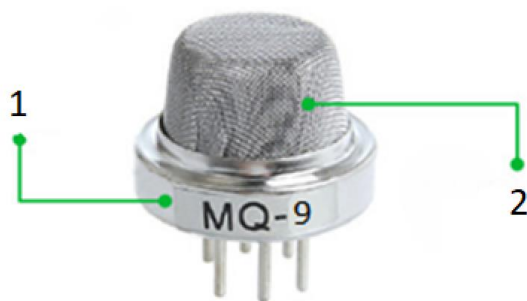
Рисунок 2.1 — Зовнішня будова давача MQ-9: 1 - зажимне кільце; 2 - проти-вибухова сітка
