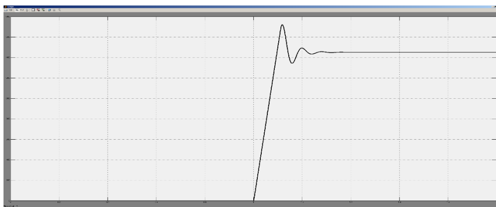
Рисунок 2.7 - Результат моделювання асинхронного електродвигуна насоса
