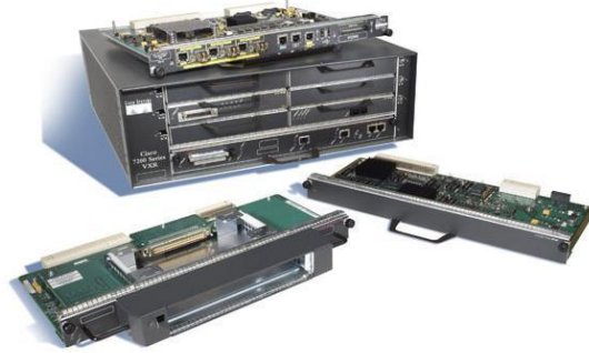
Рисунок 3.5– Маршрутизатор Cisco серії 7200 в розібраному вигляді
