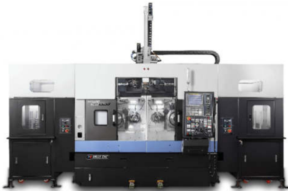
Рисунок 2.2 – Загальний вигляд верстату з двома шпинделями моделі DOOSAN серії PUMA TW2600 / M [5]
