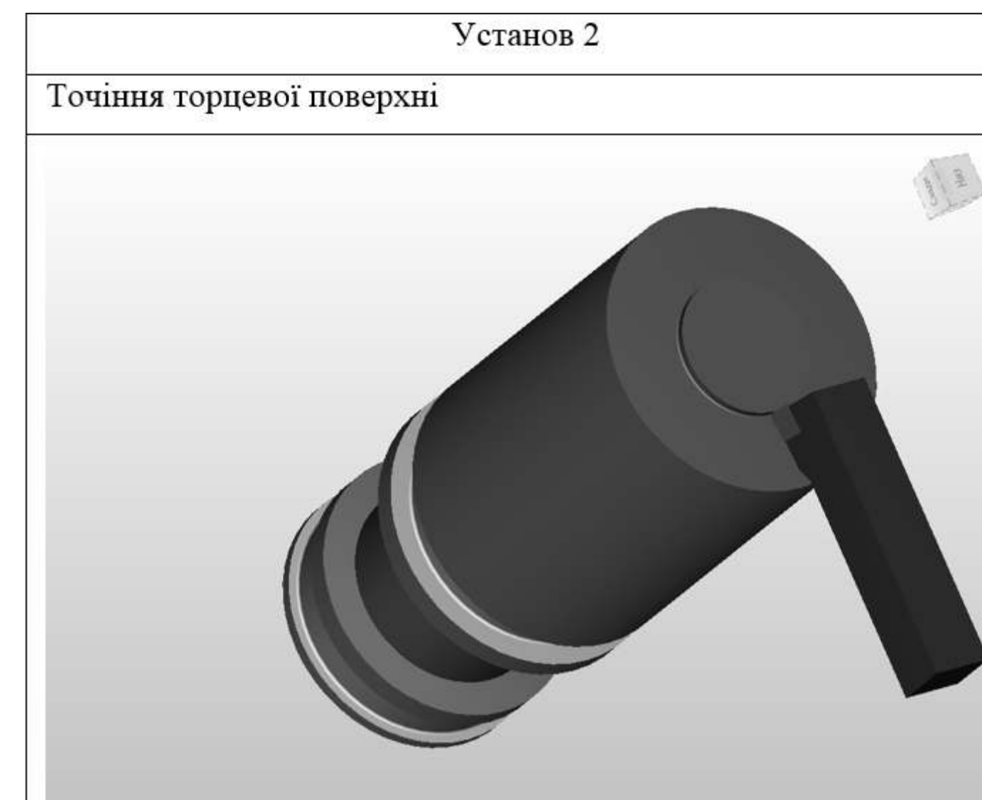
Рисунок 4.4 – 3D-модель деталі «Гільза» у програмі FeatureCAM.
