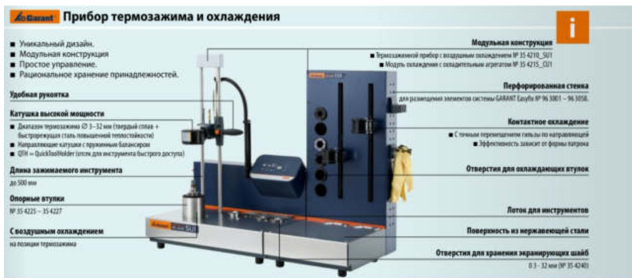
Рисунок 3.41 - Прилад термозажиму та охолодження для закріплення інструменту
