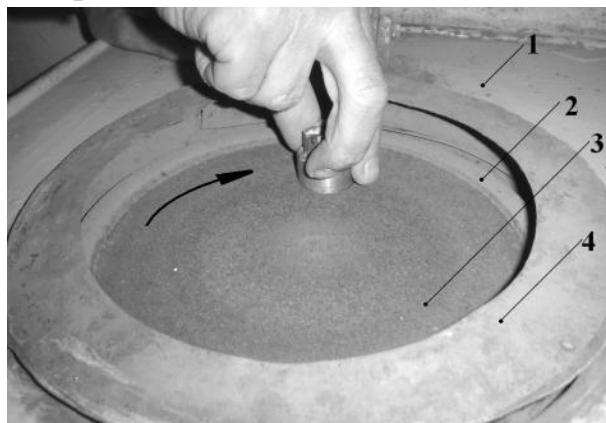
Рис. 2. Рекомендований прийом полірування шліфа на полірувальній установці: 1 – стіл полірувальної установки, 2 – диск, 3 – сукно, 4 – захисний кожух
