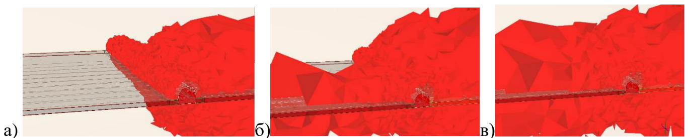
Рис. 20. Зони руйнування навколо виробок: а - формування виробленого простору першої лави; б - формування виробленого простору другої лави та заповнення першої лави дезінтегрованою масою; в - просування вибою другої лави
