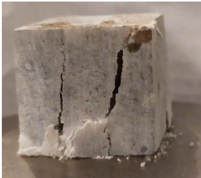
Рис. 3. Зразок гіпсу, нижня границя якого оброблена мастилом, після одноосьового навантаження
