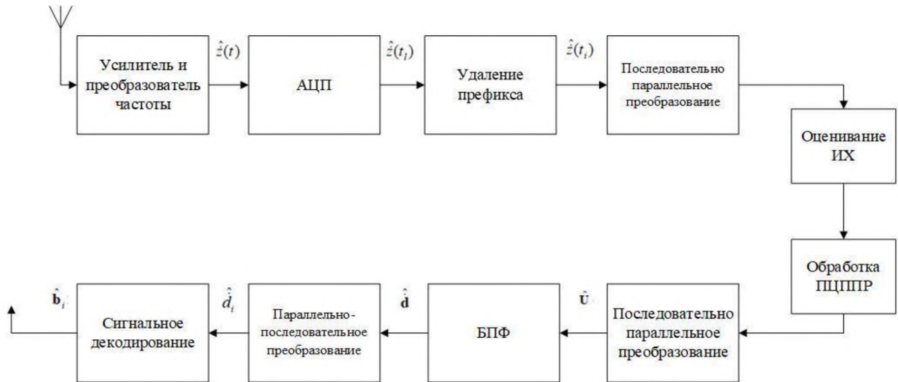
Рисунок 1.15 - Структурна схема прийому OFDM сигналу з алгоритмом ПЦППР в каналах з пам'яттю
