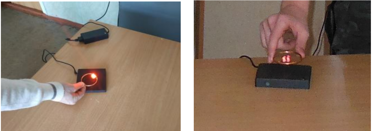
Рисунок 2 – Практичне дослідження системи безпроводної передачі електроенергії
