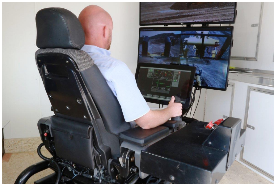
Рисунок 3.6 - Віддалена кабіна оператора гусеничного бульдозера Подібна технологія відокремлення оператора від самого обладнання в першу чергу спрямована на підвищення безпеки ведення робіт та виключення
