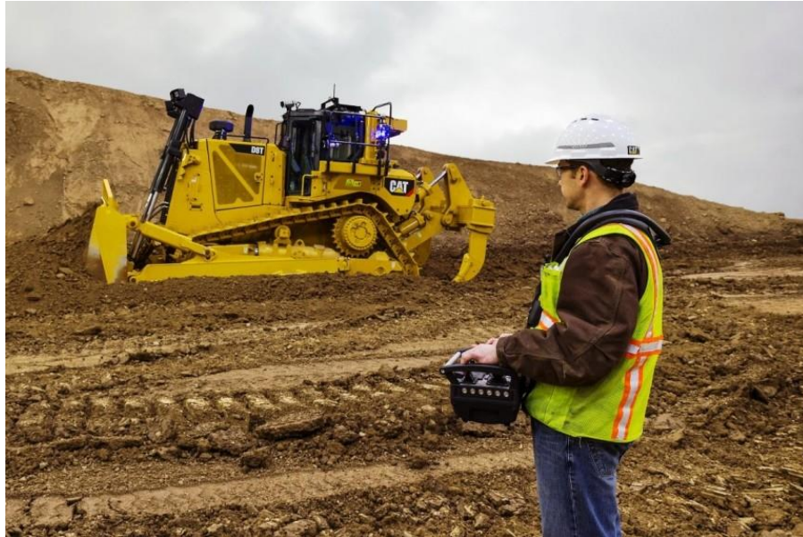
Рисунок 3.5 - Керування бульдозером за допомогою системи Cat Command у прямій видимості
