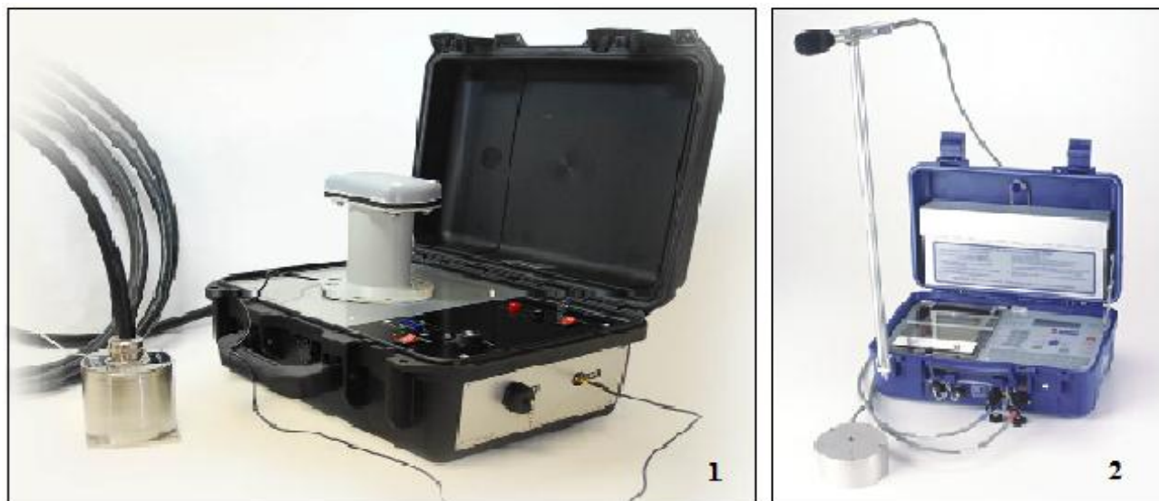
Рис. 2.2 - Обладнання для реєстрації сейсмоколивальнь ґрунту та тиску на фронті ударної повітряної хвилі: 1 - сейсмостанція ZET 048-E; 2 – сейсмограф BlastMate III
