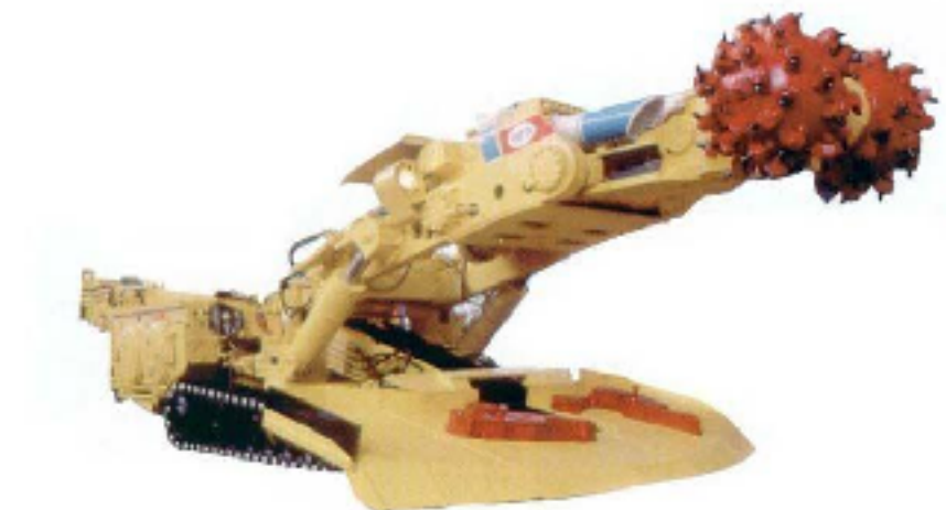
Рисунок 2.1 – Прохідницький комбайн П-110.
