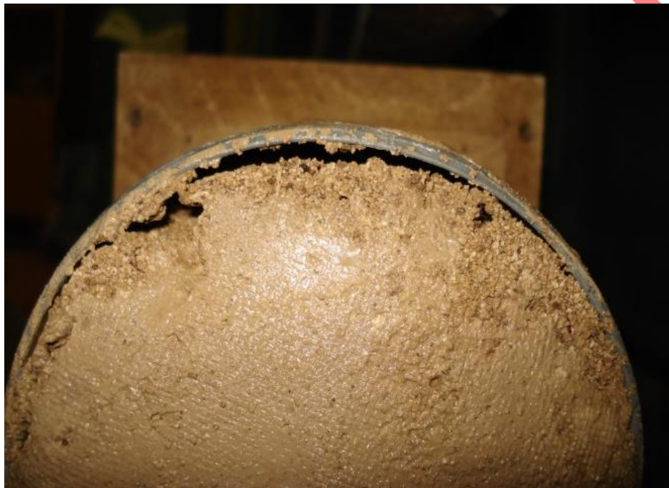
Рисунок 6.2 - Переріз ґрунту у пластиковій трубі, після закінчення досліду.
