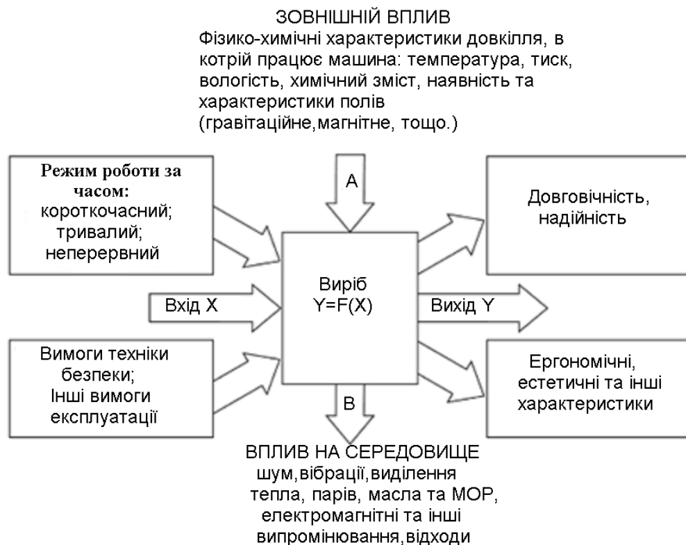
Рис. 1.5. Схема взаємодії факторів при виготовленні деталі на обробному центрі з ЧПУ
