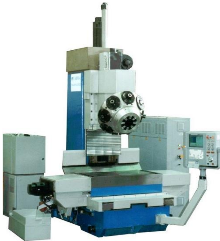
Рис. 1.1. Обробний центр з ЧПК (вертикального типу)
