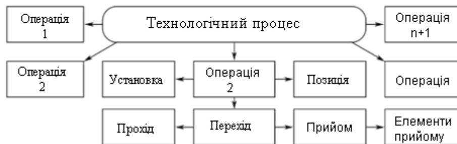
Рис. 1.4. Структурна схема технологічного процесу виготовлення деталі на обробному центрі з ЧПК
