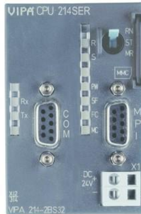
Рисунок 1.11 – Програмований логічний контролер VIPA 214-2BS33
