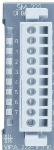
Рисунок 1.14 – Модуль дискретних виходів VIPA 222-1FD10
