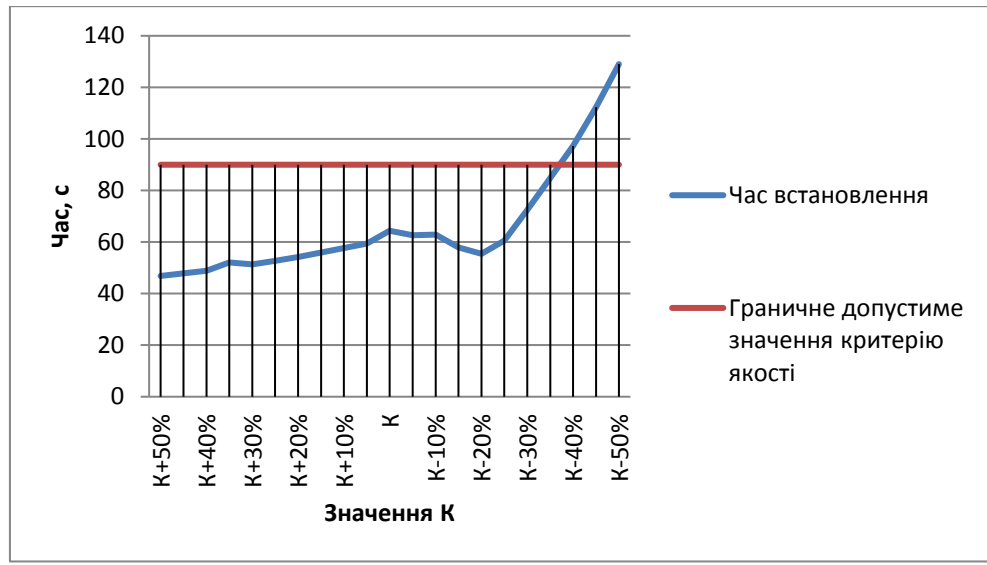
Рисунок 3.20– Залежність часу встановлення від К
